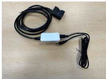
Connectez le COM-RS485 du chargeur nemo au câble d'interface et l'USB à l'ordinateur portable.
