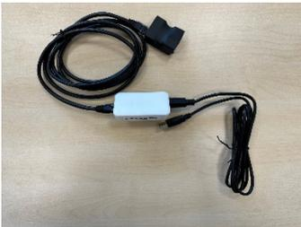
Conecte o COM-RS485 do carregador nemo ao cabo de interface e o USB ao laptop.
